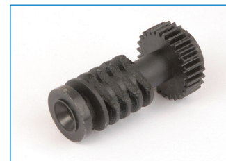
Fallo del engranaje helicoidal debido a restricción en el mecanismo de la geometría variable.
