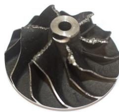
Corrosión puntual en los álabes del compresor
