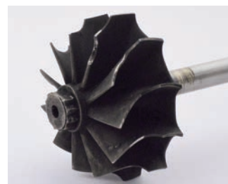
Fallo de la rueda turbina por altos HCF
