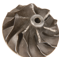
Daños en el inductor de la rueda compresora o de la turbina
