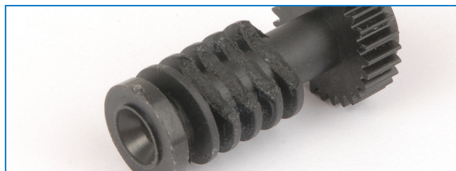
Fallo de engranaje helicoidal debido a restricción en el mecanismo de geometría variable.
